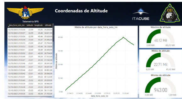
Figura 3 – Dashboard específico da altitude, contendo valores máximo, mínimo e médio, além do histórico dos dados das telemetrias mais recentes e um gráfico de altitude por hora.
