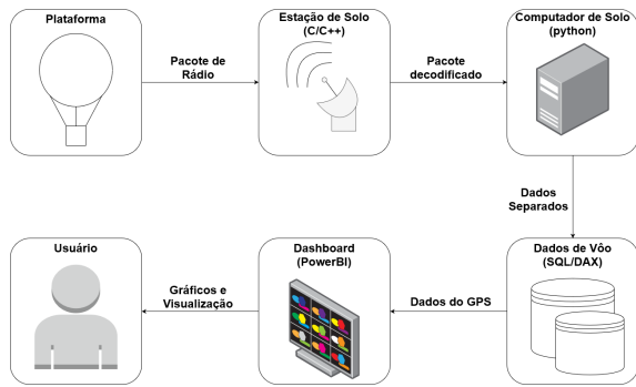
Figura 1 – Diagrama do processo de aquisição dos dados, sua telemetria, tratamento e interface intuitiva dos mesmos ao usuário.
