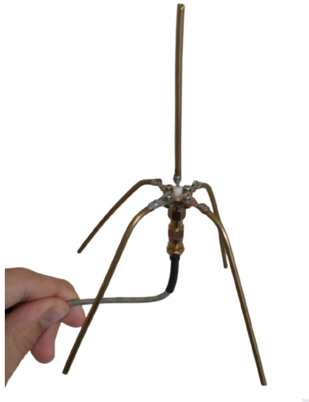
FIGURA 4.10 – Antena plano terra um quarto de onda fabricada para o STBM. Fonte: Autor.
