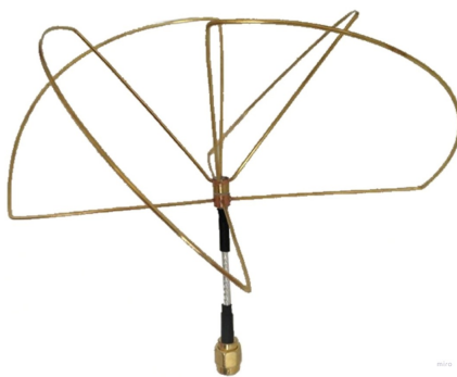
FIGURA 2.7 – Antena Folha de Trevo. Fonte: Autor.
