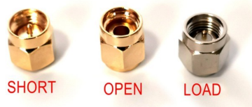
FIGURA 4.17 – Cargas de calibração do nano VNA. Fonte: Autor.
