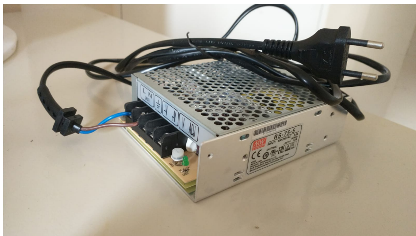
FIGURA 4.20 – Fonte AC-DC com saída de 5 V empregada na estação de solo. Fonte: Autor.
