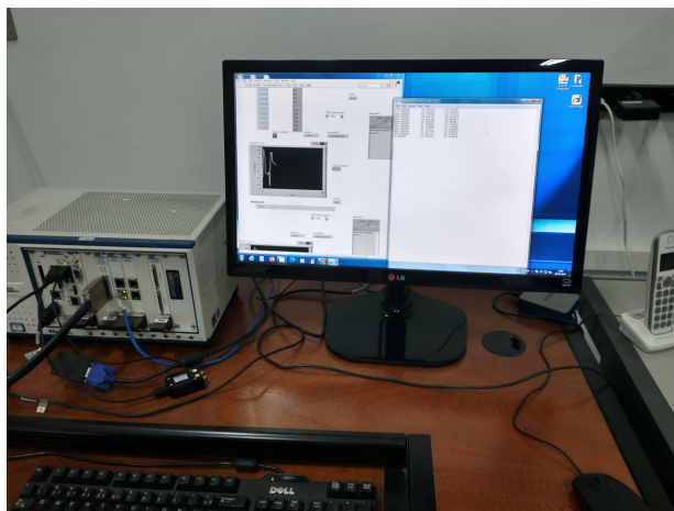
FIGURA 4.13 – Sistema de aquisição de dados da câmara anecoica do IFI durante a realização do ensaio. Fonte: Autor.
