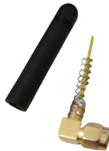
FIGURA 2.6 – Antena helicoidal ou rubber ducky antenna ao lado de seu encapsulamento. Fonte: Autor.
