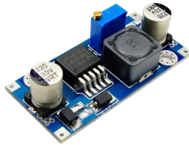
FIGURA 3.9 – Módulo regulador de tensão Step Down . Fonte: Autor.
