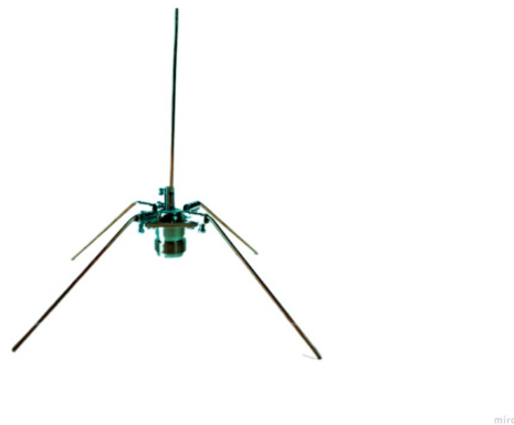
FIGURA 2.5 – Antena monopolo um quarto de onda com plano terra formado por quatro elementos inclinados a 45^\circ . Fonte: Autor.
